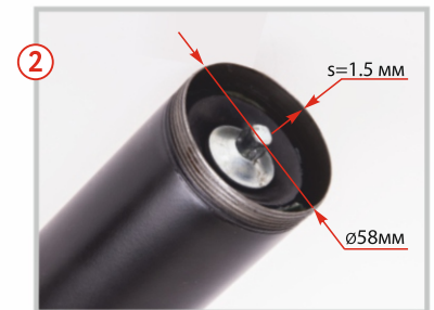
2 Корпус d 58 мм виконаний з металу 1,5 мм підвищеної міцності, аналог ГОСТ 19281. Різьба трапецеїдальна зносостійка, не боїться "злизування"
