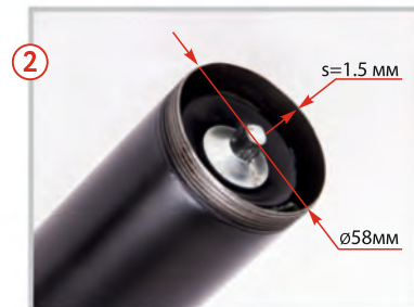
2 Корпус d 58 мм виконаний з металу 1,5 мм підвищеної міцності, аналог ГОСТ 19281. Різьба трапецеїдальна зносостійка, не боїться "злизування"
